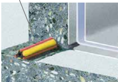
TECNOLOGÍA DE JUNTAS Juntas de construcción
