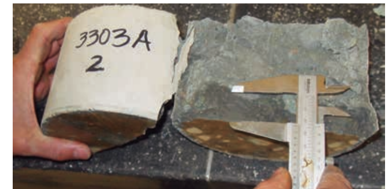
Efecto de la relación Agua/cemento y la dosis del impermeabilizante Sika® WT-100 sobre la penetración de agua de acuerdo al ensayo EN 12390-8
